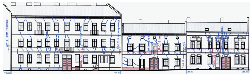
Рис. 2. Тріциноутворення на фасадах житлових будинків старої забудови
