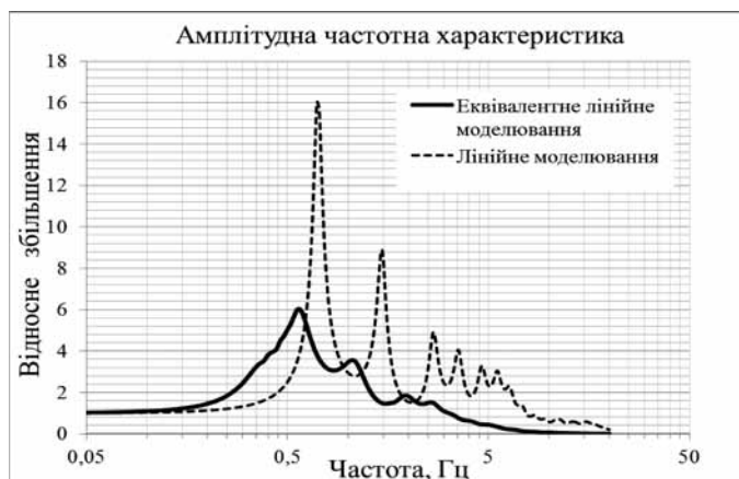
Рис.1. Амплітудно-частотна характеристика ґрунтового середовища під будівельним майданчиком на проспекті Оболонському (біля озера Опечень) в м. Києві, отримана а) лінійним моделюванням, в) еквівалентним лінійним моделюванням з використанням програмного комплексу ProShake.
