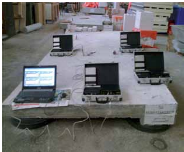
Рис.3. Определение динамических характеристик резинометаллических сейсмоизолирующих опор.
