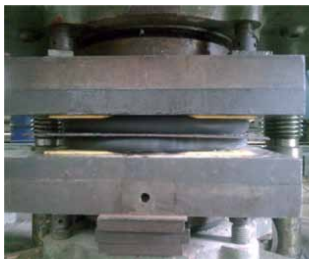
Рис.4. Общий вид РСБ диаметром 500 мм под нагрузкой 3000 кН (испытания на прессе).
