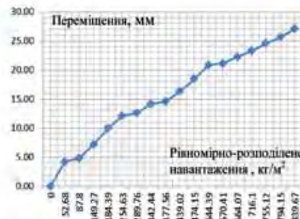
Рис.14. Характерні графіки переміщень в місці максимального прогину зразка: а - середня вісь крайнього прогону (П9), б - ліва вісь крайнього прогону (П1)
