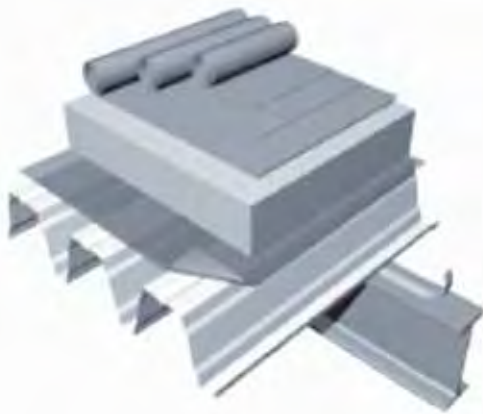
Рис. 3. Конструктивне рішення покриття з профільованим металевим листом.
