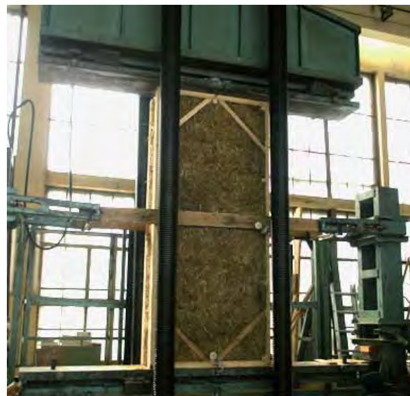
Рис.6. Випробування стінової панелі ПС на пресі ИПС-1000.
