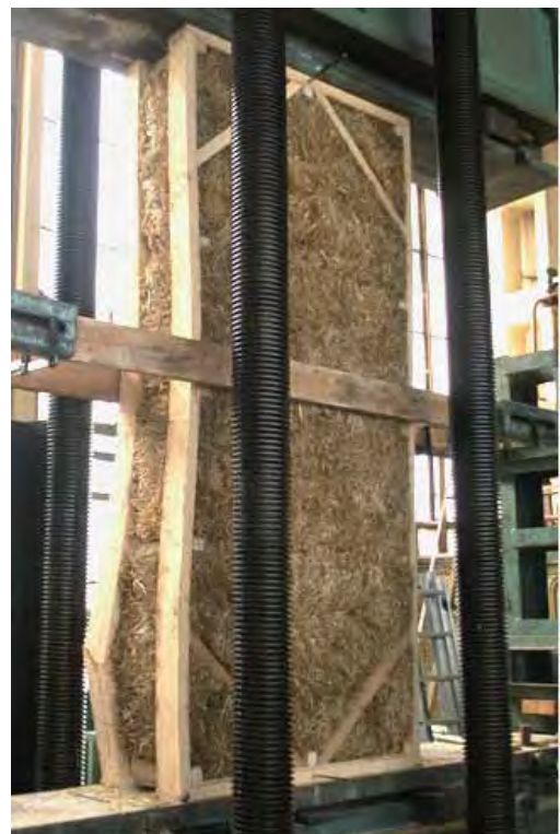
Рис.10. Руйнування зразка стінової панелі ПС-2 через втрату стійкості та злому дерев'яних стійок.
