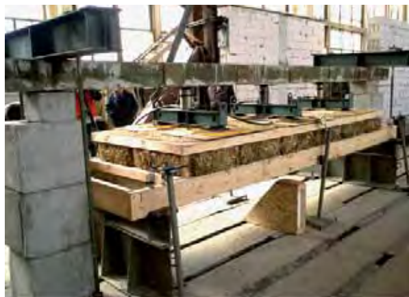
Рис.12. Загальний вигляд випробування панелі перекриття.
