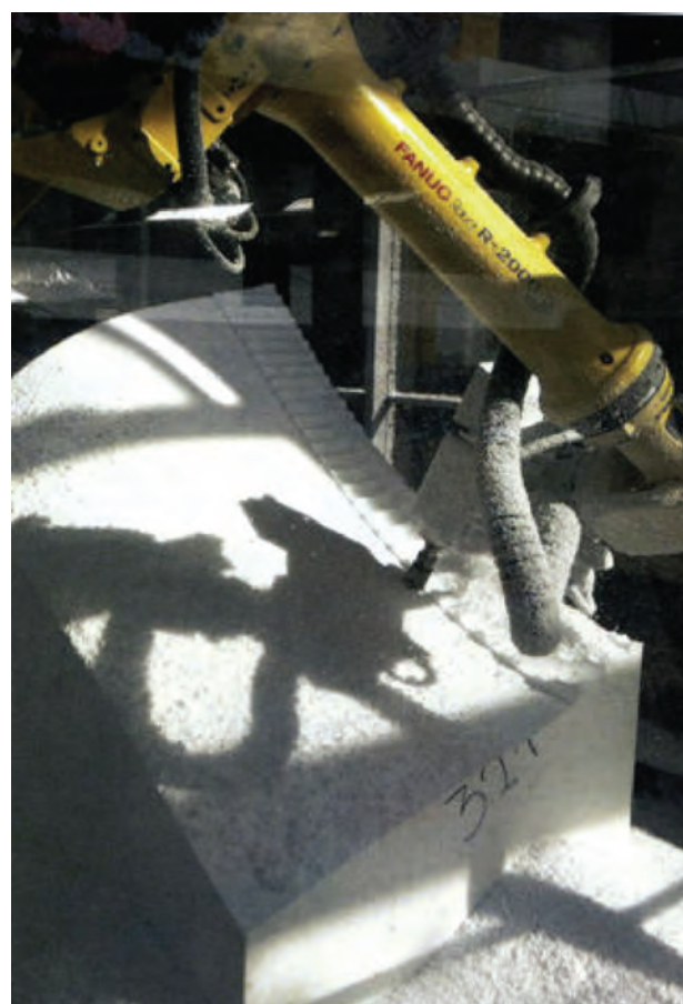
Рис.1. Современные технологии возведения криволинейных конструкций: а – несъемная опалубка из водостойкой фанеры [11]; б – изогнутые стены музея [11]; в) – арматурный каркас для акустических оболочек [12]; г – изготовление опалубки из пенополистирола [13]
