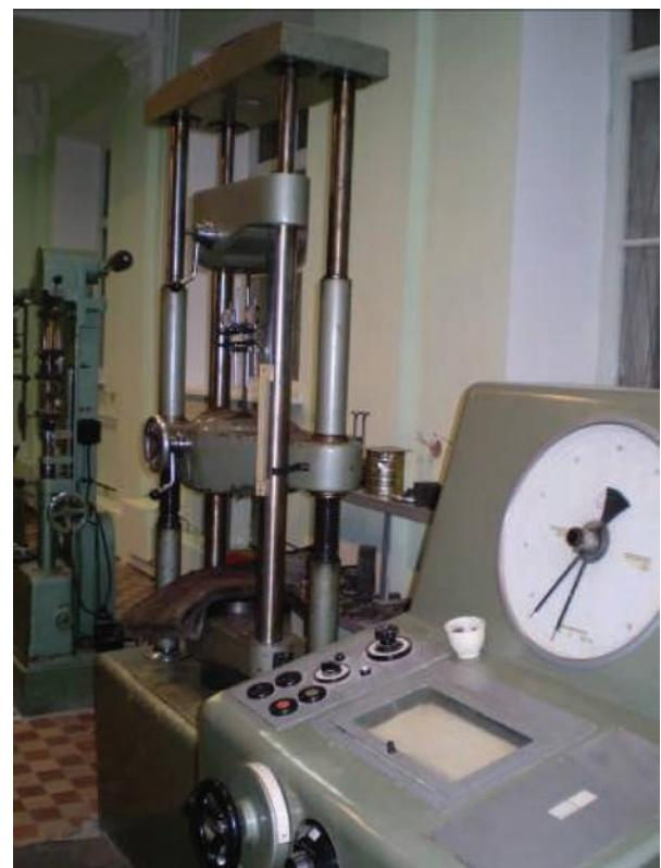
Рис.3. Общий вид испытаний механических соединений арматуры диаметром 12 мм с конической резьбой муфтами Lenton на разрывной машине ZD-40.
