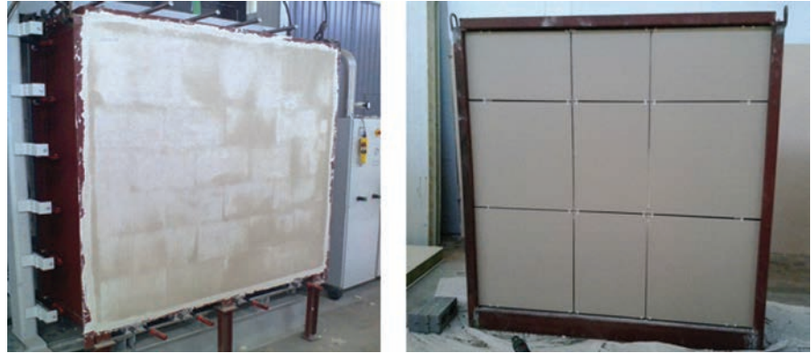
Рис.1. Вигляд кладки на основі багатошлішних керамічних блоків з внутрішньої (а) та зовнішньої (б) сторони.
