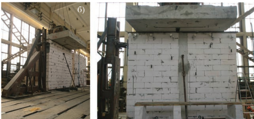
Рис.3. Схема испытательного стенда с приложением горизонтальной (сейсмической) нагрузки справа при монотонном нагружении (а) и общий вид простенка без сердечника (б) и с сердечником (в), нагруженных вертикальной и горизонтальной нагрузками, при испытаниях
