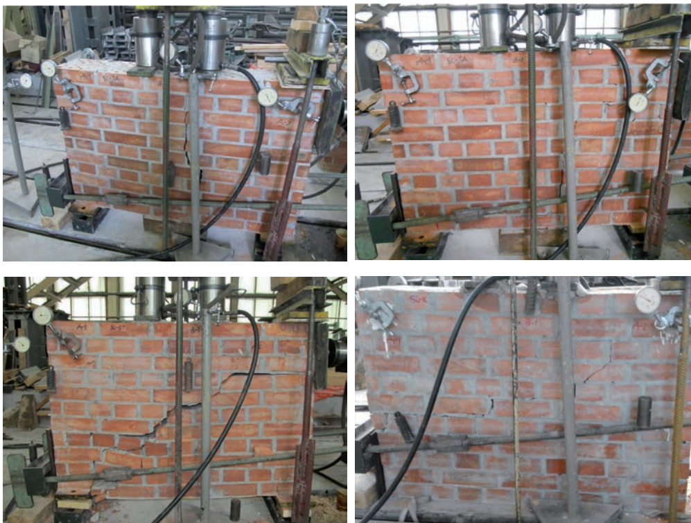
Рис.1. Зовнішній вигляд зразків балок-стінок за результатами випробувань: а – БС-ТД після першого етапу; б – БС-ТД після остаточного руйнування від горизонтальної сили; в – БС-БТ після остаточного руйнування від горизонтальної сили; г – БС-К після остаточного руйнування від горизонтальної сили
