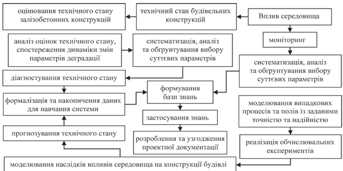
Рис. 3. Схема формування бази знань системи оцінювання технічного стану будівельних конструкцій
