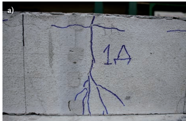
Рис. 3. Руйнування зразка балки, армованої стержнем базальтопластикової арматури \emptyset 8 , після 2 млн. циклів а) загальний вигляд зруйнованого зразка; б) крупний план руйнуючої тріщини
