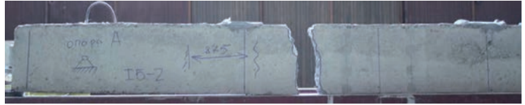
Рис. 1. Руйнування зразка балки, армованої стержнем базальтопластикової арматури \emptyset 4 , після 2 млн. циклів
