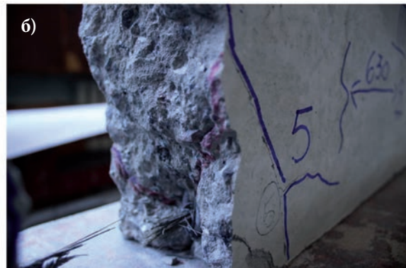
Рис. 3. Руйнування зразка балки, армованої стержнем базальтопластикової арматури \emptyset 8 , після 2 млн. циклів а) загальний вигляд зруйнованого зразка; б) крупний план руйнуючої тріщини
