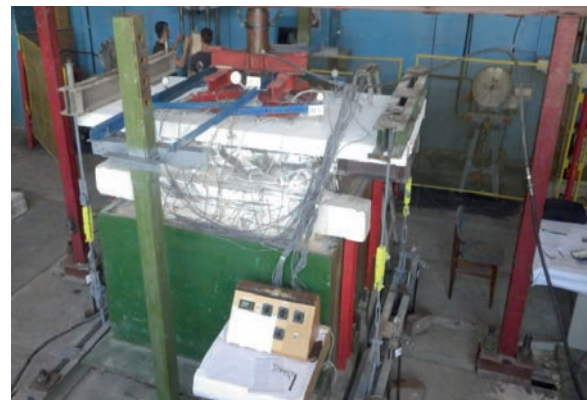
Рис. 5. Размещение измерительных приборов, термопар, вторичного устройства для замера температур
