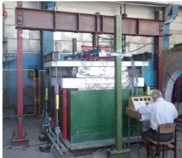
Рис. 4. Общий вид установки для испытания модели фрагмента моста при нагреве
