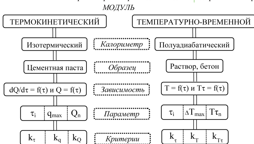
Рис. 3. Алгоритм получения калориметрической информации
