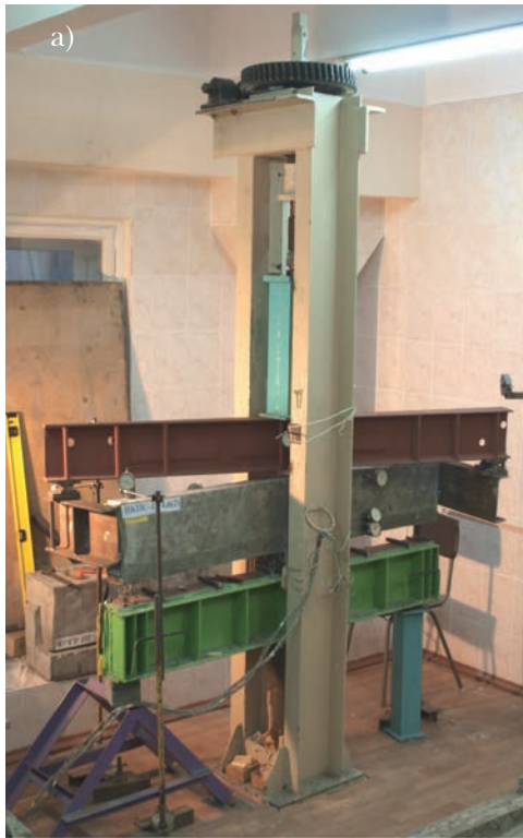
Рис. 2. Экспериментальная установка (с заданием деформационного воздействия) для проведения исследований железобетонных конструкций (в том числе составных) прямоугольного сечения при кручении изгибом: а – фронтальный вид; б – боковой вид
