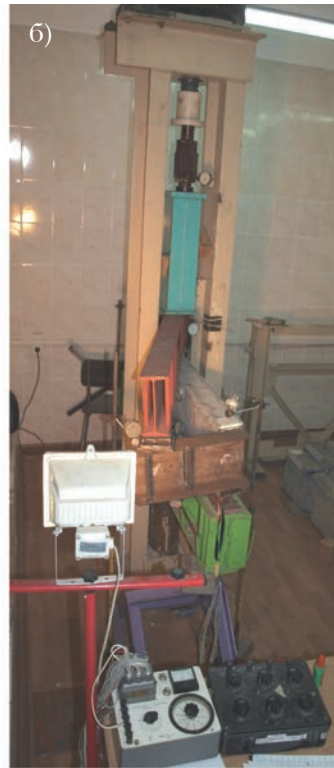
Рис. 2. Экспериментальная установка (с заданием деформационного воздействия) для проведения исследований железобетонных конструкций (в том числе составных) прямоугольного сечения при кручении изгибом: а – фронтальный вид; б – боковой вид
