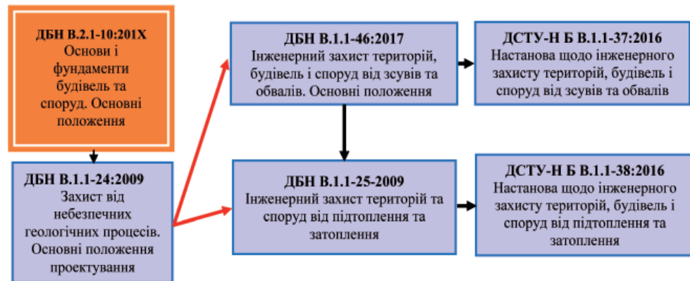
Рис. 3. Структура комплексу норм і стандартів щодо проектування основ і фундаментів споруд в зоні впливу небезпечних геологічних процесів
