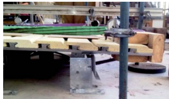
Рис. 6. Деформація (депланация) ригеля каркаса від дії власної ваги зразка фасадної системи та обledenіння
