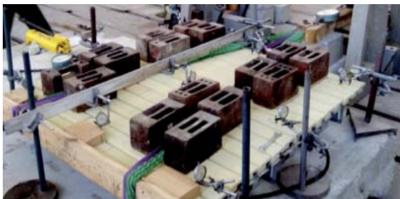
Рис. 5. Зразок фасадної системи під вітровим та сейсмічним активним навантаженнями
