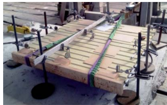
Рис. 4. Зразок фасадної системи, підготовлений до випробувань
