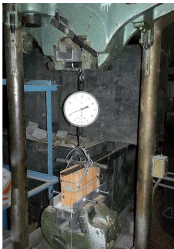
Рис. 4. Дослідний зразок мурування для визначення міцності зчеплення за методикою ДСТУ Б В.2.6-174:2011
