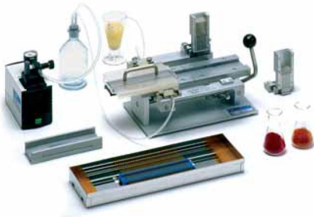
Рис. 3. Напівавтоматична фасувально-закупорювальна система SFS 133 сперми жеребців
