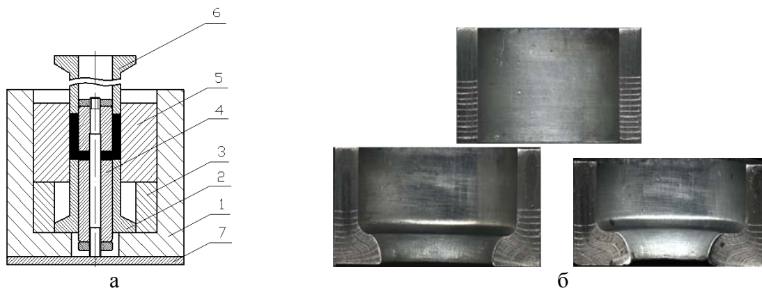
Рис. 1. Штамповая оснастка и картины поэтапного изменения делительной сетки
