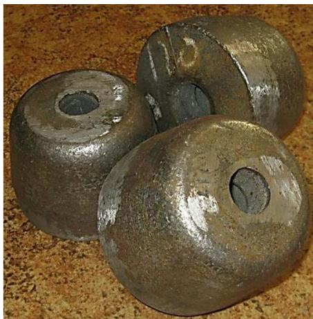
Рис. 1. Заготовки оправок для волочения труб (производство Днепропетровского трубного завода)
