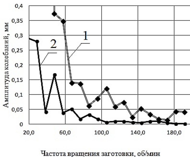
Рис. 3. Амплитуда колебаний в зоне контакта круга и заготовки в зависимости от ее частоты вращения
