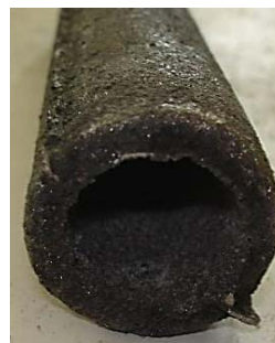
Рис. 8. Виливок (внутрішній діаметр 22 мм) після вилучення стрижня
