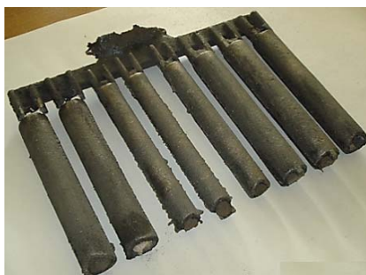
Рис. 7. Блок виливків (СЧ20), отриманий з використанням стрижнів із сумішей з фосфатами алюмінію
