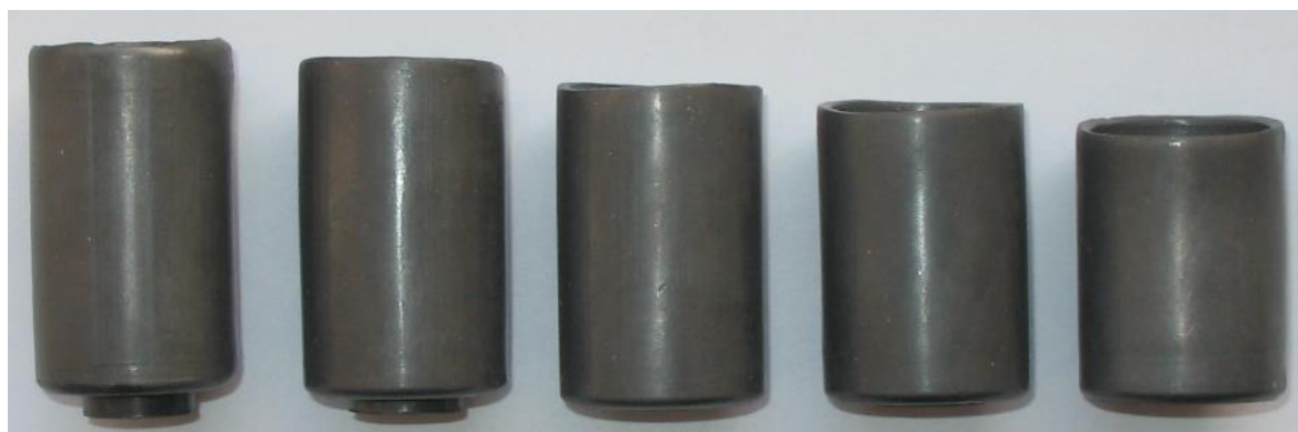
Рис. 6. Полые детали и деталь типа «крестовина», полученные радиально-прямым вы- давливанием с раздачей
