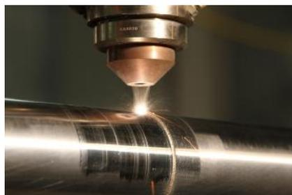
Рис. 3. Схема плазменной наплавки с вдуванием порошка в дугу
