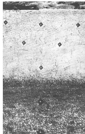
Рисунок 3. Мікроструктура (x400) сталі 65Г після МІО
