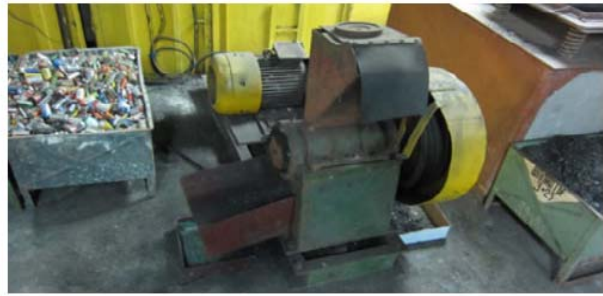
б) перемел батарейок спеціальним шредером
