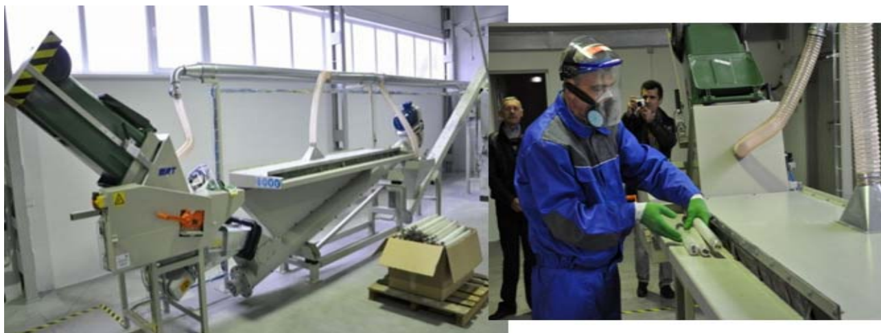
Рис. 6. Технологічна лінія на Львівському підприємстві з утилізації відпрацьованих енергозберігаючих ламп
