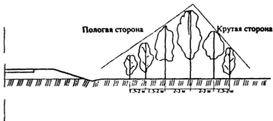
**Рис. 1. Схема шумо-газо-пылезащитных насаждений**
