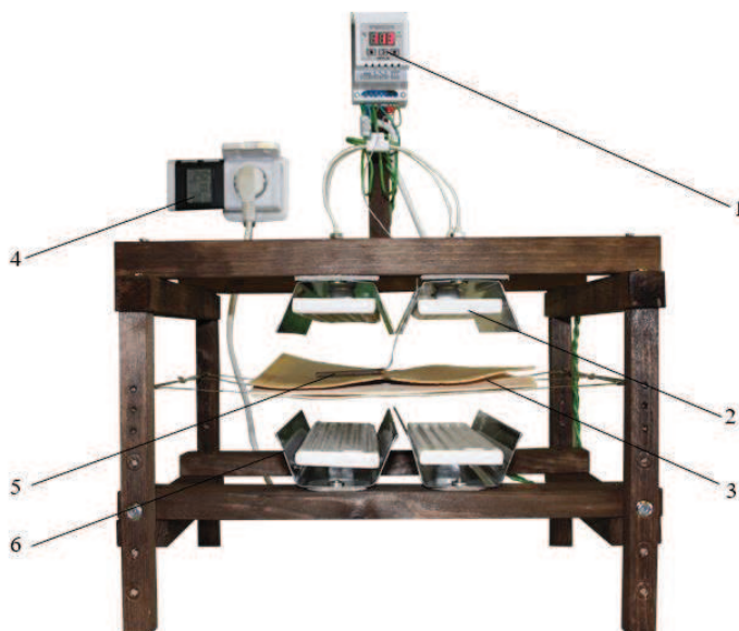
Рис. 1. Загальний вигляд пристрою для прогрівання інфрачервоним випромінюванням: 1 – терморегулятор; 2 – інфрачервоний випромінювач; 3 – пакет шпону; 4 – пристрій для вимірювання витрати електроенергії; 5 – термопара; 6 – рефлектор інфрачервоного випромінювача
