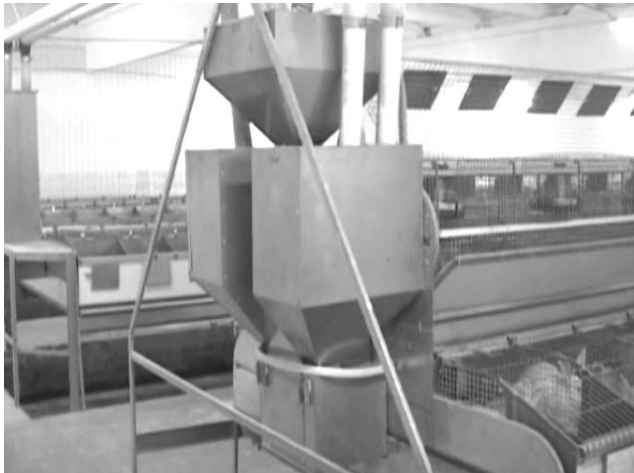
Рис. 5. Обладнання для роздавання кормів у крільчатнику.
