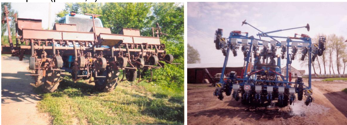
Рис. 1. Бурякова сівалка ССТ–18М у робочому (а) і транспортному положенні (б).
