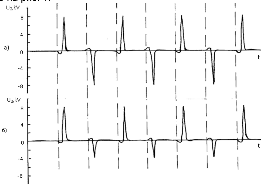
Рис. 1. Осцилограми вихідних сигналів генератора високовольтного пульсуючого електричного поля без випрямлення (а) і з випрямленням (б)
