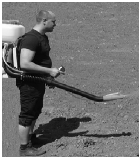
Рис. 3. Процес нанесення живильних розчинів електростатичним методом Технічна характеристика електростатичного розпилювача
