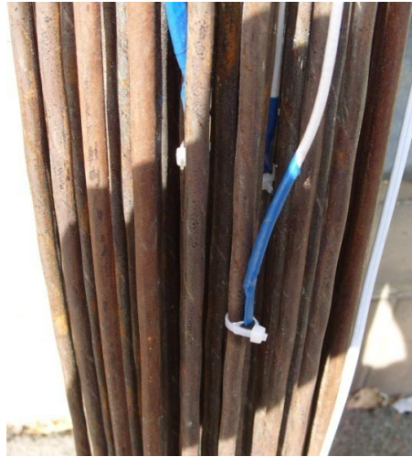
Рис 6. Встановлення датчиків температури на стержні
