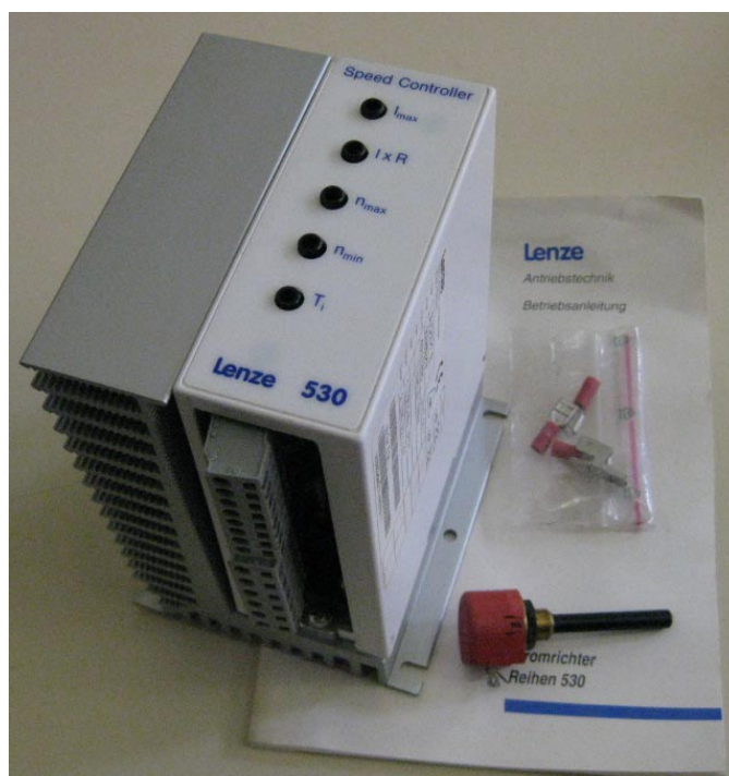
Рис. 1. Зовнішній вигляд тиристорного перетворювача напруги серії 530 фірми Lenze
