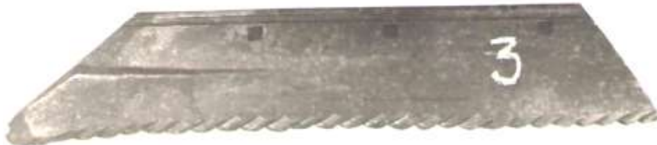
Рис. 8. Леміш плуга після наробітку 49 га.
