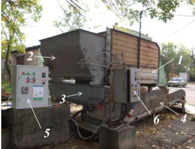
Рис. 1. Експериментально дослідна установка на базі змішувача-кормороздавача потокового типу: 1 – бункер-дозатор стеблових кормів; 2 – бункер-дозатор концкормів; 3 – лопатевий змішувач; 4 – стрічковий транспортер; 5 – блок керування електродвигуном та вимірювання споживаної потужності; 6 – щиток керування електродвигунами.
