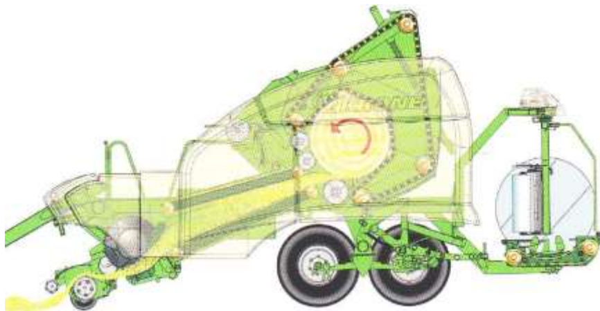
Рис. 1. Функціональна схема прес-подрібнювача-підбирача.
