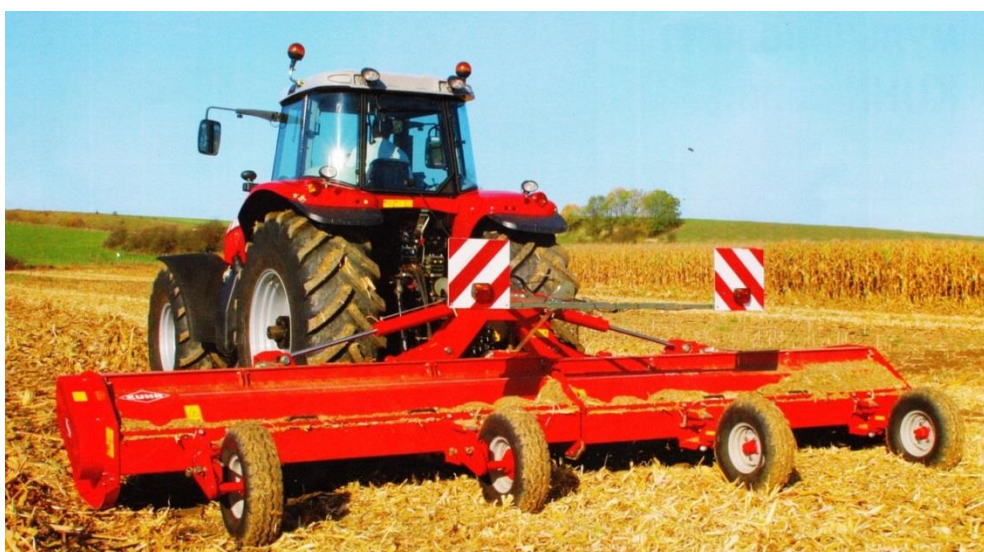
Рис. 1. Агрегат для подрібнення рослинних решток (MF 6499 + RM 610R).
