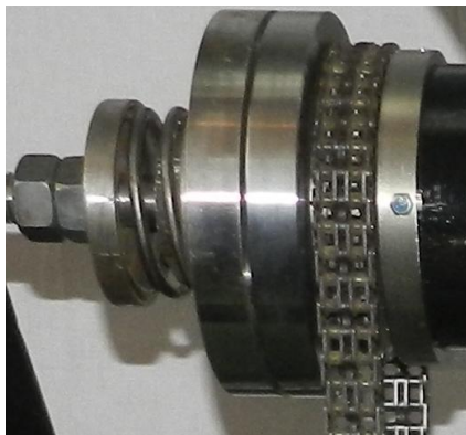
Рис. 2. Конструктивна схема (а), загальний вигляд (б) запобіжного пристрою та загальний вигляд (в) робочої поверхні ведучої півмуфти
