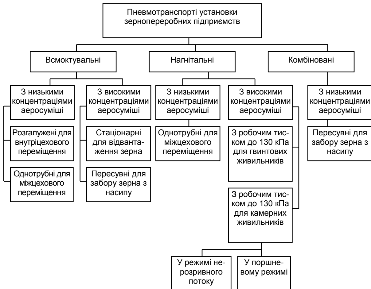
Рис. 1. Класифікація пневмотранспортних установок
