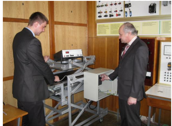
Рис. 4. Доценти В.В. Савченко та О.Ю. Синявський проводять дослідження електротехнологічного комплексу для магнітної обробки сільськогосподарської продукції
