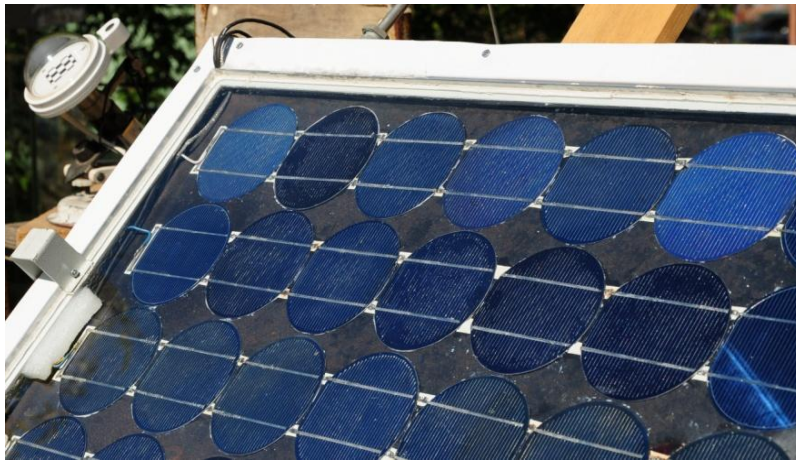
Рис.3. Внешний вид разработанного макета ФЭТ модуля
