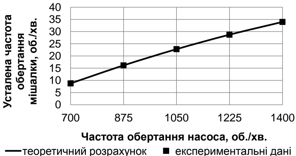
Рис. 3. Залежність усталеної частоти обертання гідрореактивної лопатевої мішалки в залежності від частоти обертання насоса при куті установки лопаток 60^{\circ} .
