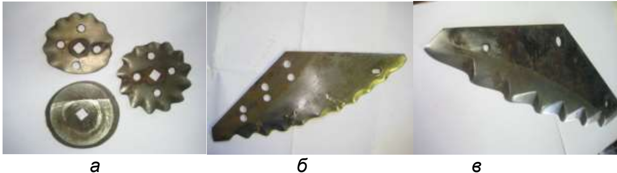
Рис. 2. Місця зношування ножів: а – ножі подрібнювача-змішувача з горизонтальним розміщенням шнека, б – ніж подрібнювача-змішувача з вертикальним розміщенням шнека та регулюванням кута атаки, в – ножі подрібнювача-змішувача з вертикальним розміщенням шнека.
