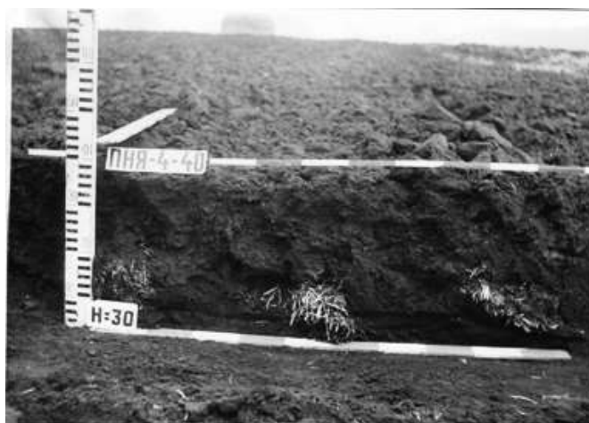
Рис. 3. Поперечний переріз поля після проходження плуга ПНЯ-4-40С напівгвинтовими корпусами верхнього ярусу.
