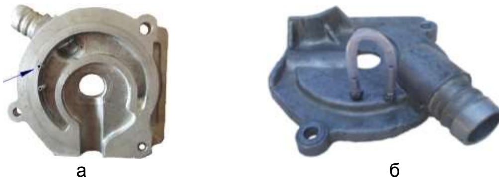
Рис. 3. Датчик команди скидання насінин при пропусках в роботі основного дозатора: а – датчик команди; б – перепускний клапан.
