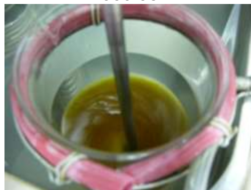
Рис. 4. Нейтралізація метилового ефіру при перемішуванні з частотою обертання валу мішалки.
