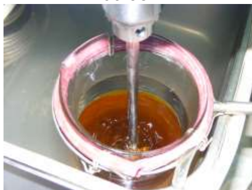
Рис. 4. Нейтралізація метилового ефіру при перемішуванні з частотою обертання валу мішалки.
