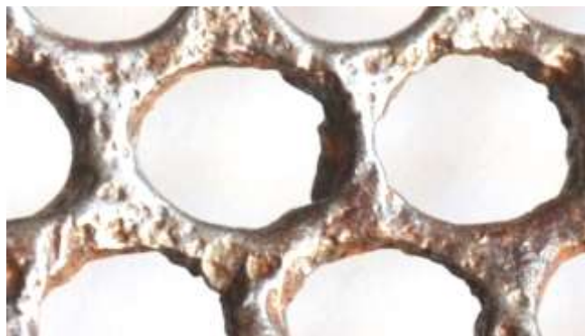
Рис. 3. Нерівномірність поверхні решета в наслідок ударів твердими вкрапленнями.
