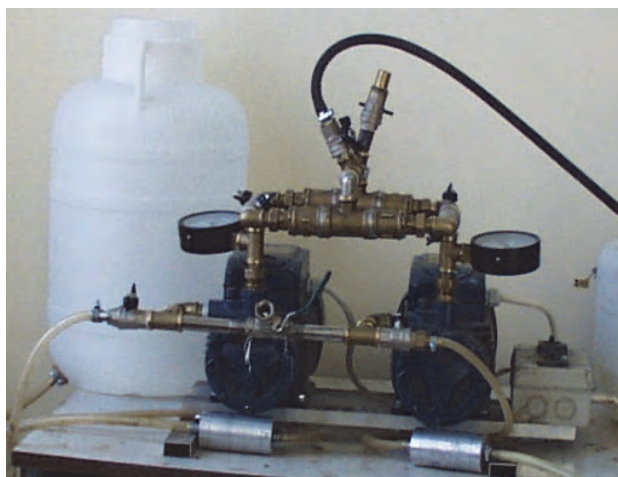
Рис. 1. Установка для получения многокомпонентного топлива производительностью 2 т/ч в отделе биоэнергетики ФГБНУ ВИЭСХ
