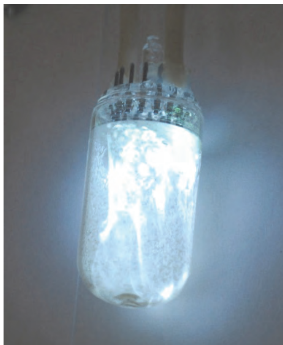
Рис. 4. Опытный образец люминесцентной лампы с холодными катодами и автоэлектронной эмиссией
